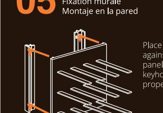
j.) Fixer ensemble par l'insertion de l'extrémité pointue de chaque goupille d'accessoire de montage dans chaque trou de coin de l'accessoire de montage. (En cas de montage vertical des panneaux multiples, fixer chacune pour assurer que les supports muraux soient parallèles).
